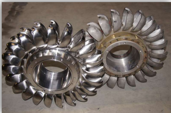
rechts das ausgemusterte Gussrad links der neue Sigris Integral Runner ®
